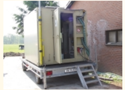
Meetunit voor stalemissiemetingen opgesteld bij Bomers in Eibergen.
