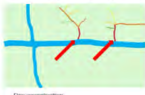
Figuur 2: Uitsnede van een afspoelkaart uit de BWW. De flow (stroom) uit de legenda geeft aan hoeveel oppervlak afwatert op het betreffende punt; hoe donkerder, hoe groter het oppervlak. Als zo'n donkere plek vlak naast de sloot ligt, zoals in de rode pijlen aangeven, is het risico op afspoeling dus groot.
